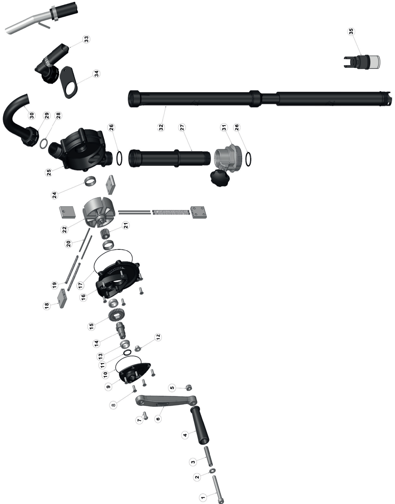
Fig. 9.-1: Vue éclatée de la pompe rotative
